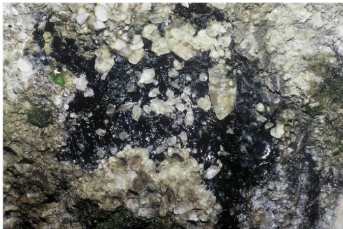
Fig. 10 - Betume que migrou da Formação de Cabaços e foi preencher os espaços entre os cristais de calcite de uma fenda de tracção nos calcários da pedreira de Rocha Forte.
